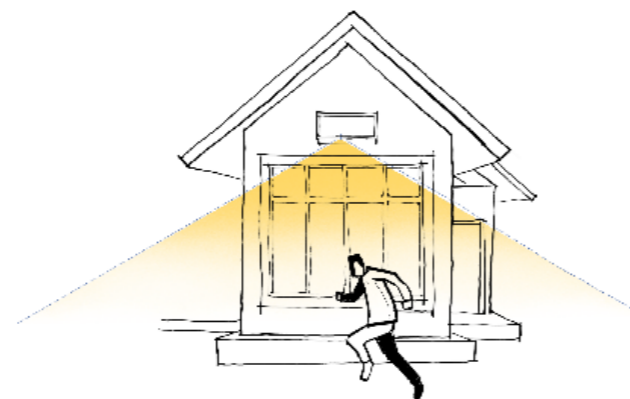
Contoh penggunaan sensor gerak pada lampu luar
