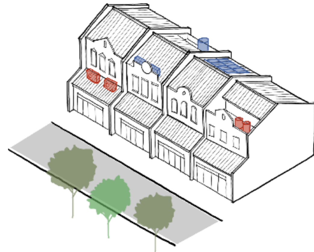
18. Adaptasi: Penambahan Alat Utilitas Tidak Mengganggu Tampilan Fasad (Gol. C)
