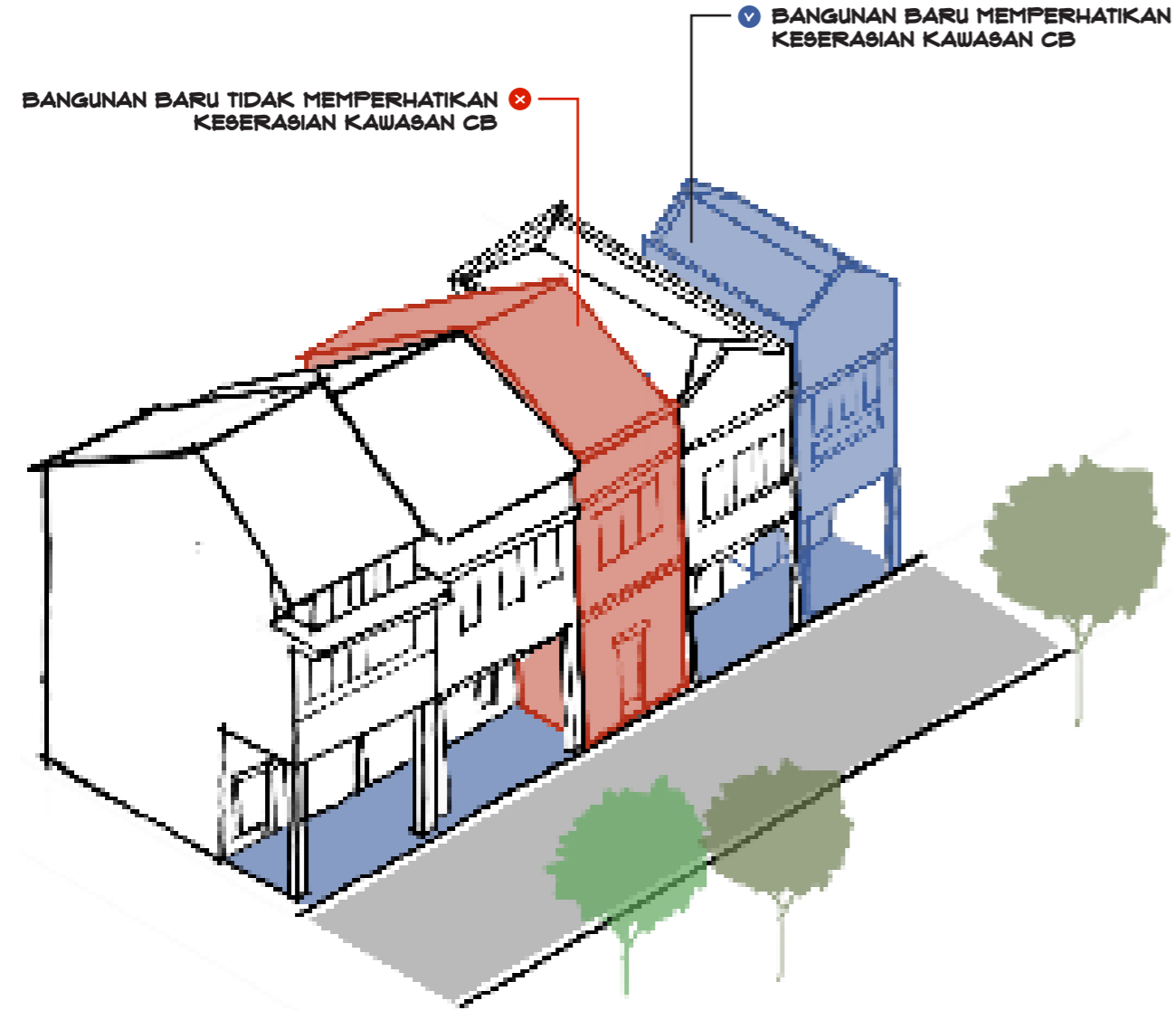
19. Infill : Bangunan Baru pada Kawasan Cagar Budaya
